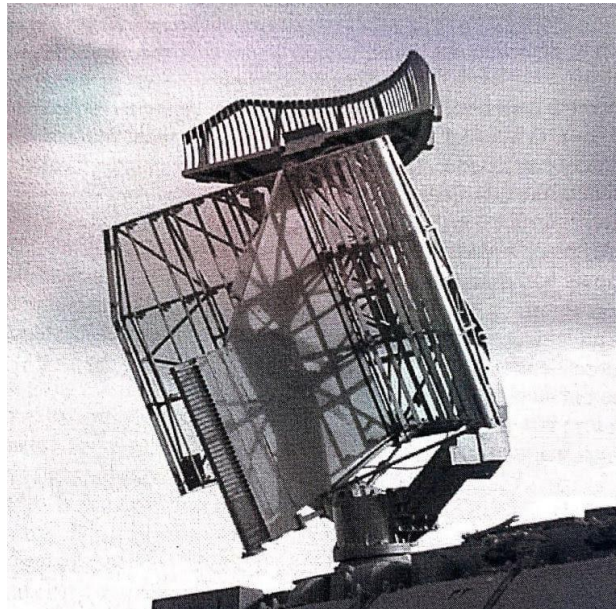
تصویر ۷-۴-آنتن شناسایی دوست یا دشمن (IFF) بالای رادار هدف‌یاب.
